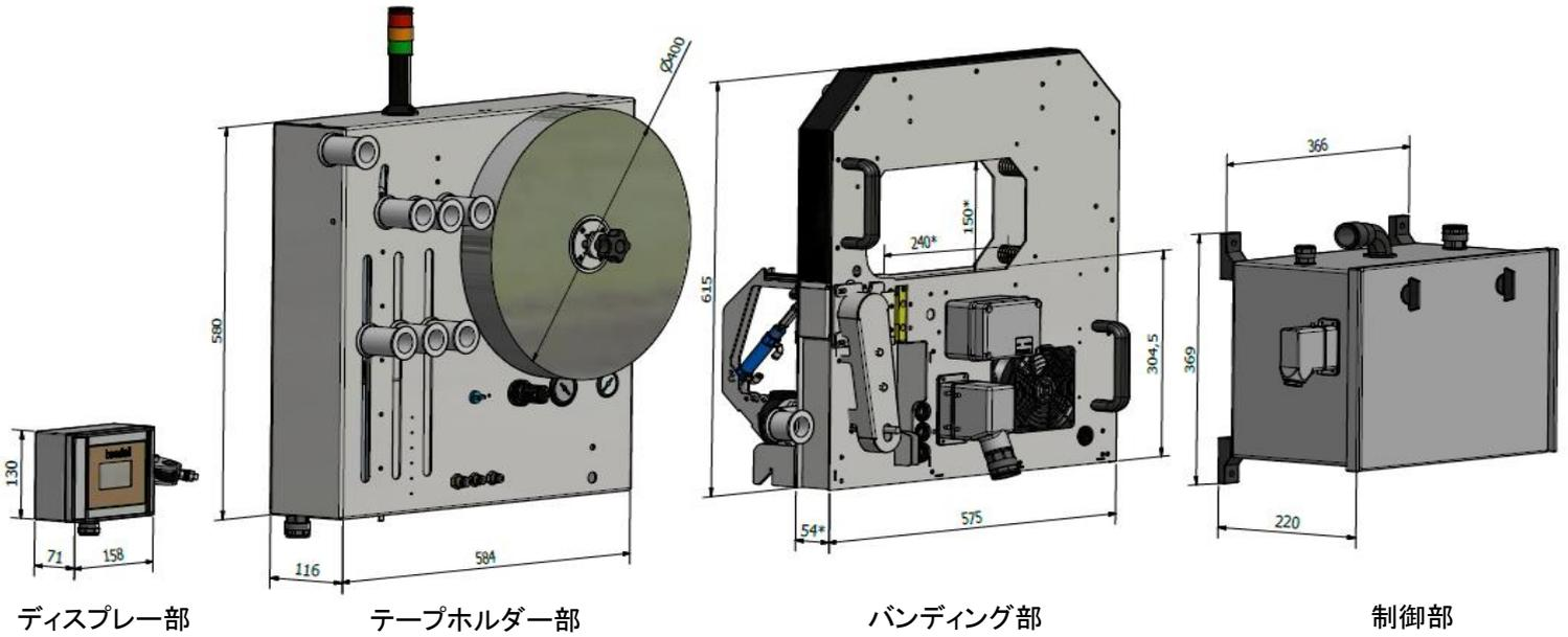
■ モジュール化された各構成部は設置場所の条件に合わせて自由に配置が可能です。
